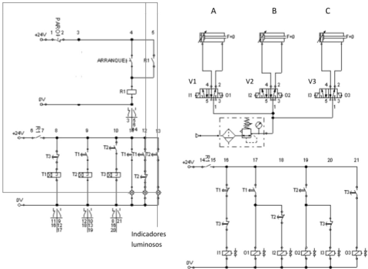
Fig. 21-1 Accionamiento de tres cilindro de doble efecto con electroválvulas direccionales.
