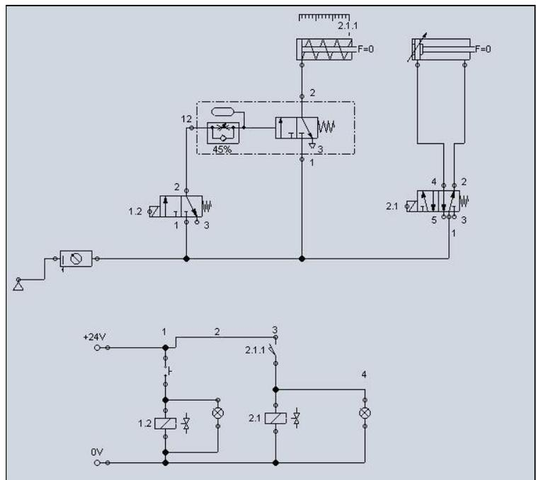
Fig. 18-1 Accionamiento de un cilindro de doble efecto con electroválvula direccional.
