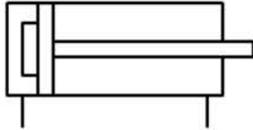
**Cilindro de doble efecto**, con amortiguación final en un lado.
