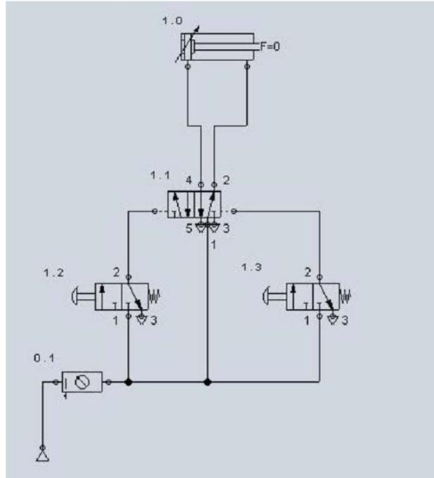
Fig. 3-2 Accionamiento indirecto de un cilindro de doble efecto, utilizando válvula conmutadora.
