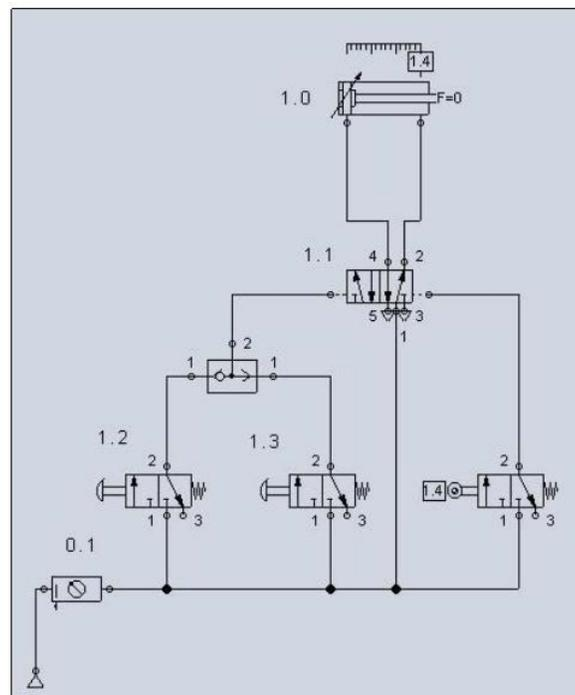
Fig. 6.2 Función Lógica O Accionamiento de cilindro de doble efecto
