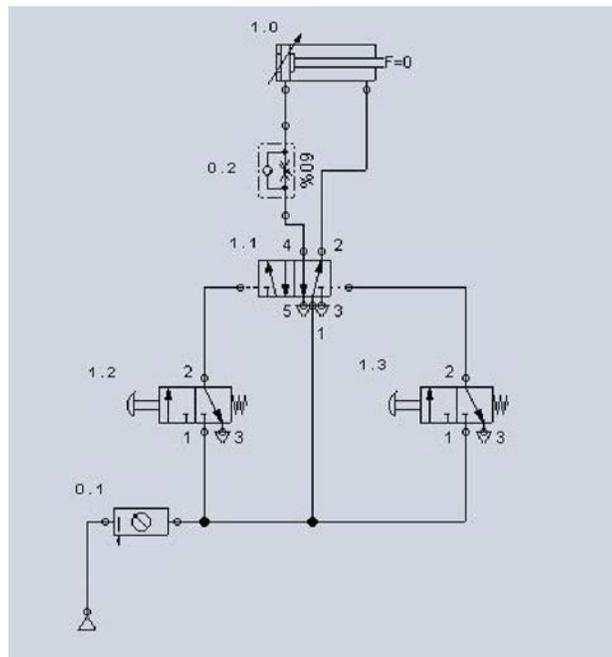
Fig. 3-3 Accionamiento indirecto de un cilindro de doble efecto,
