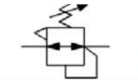
**Válvula de control de presión, Regulador de presión de alivio, regulable.**
