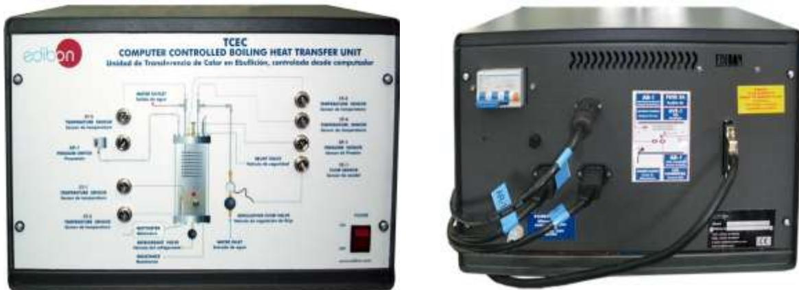
Comprobar que todos los sensores están correctamente conectados a la interface en su correspondiente clavija. Chequear con el diagrama situado en el panel frontal que los sensores requeridos para cada práctica están colocados en el lugar adecuado. **INTRODUCIR CON CUIDADO LOS SENSORES Y ACTUADORES.** Una mala conexión puede dañar la unidad.
