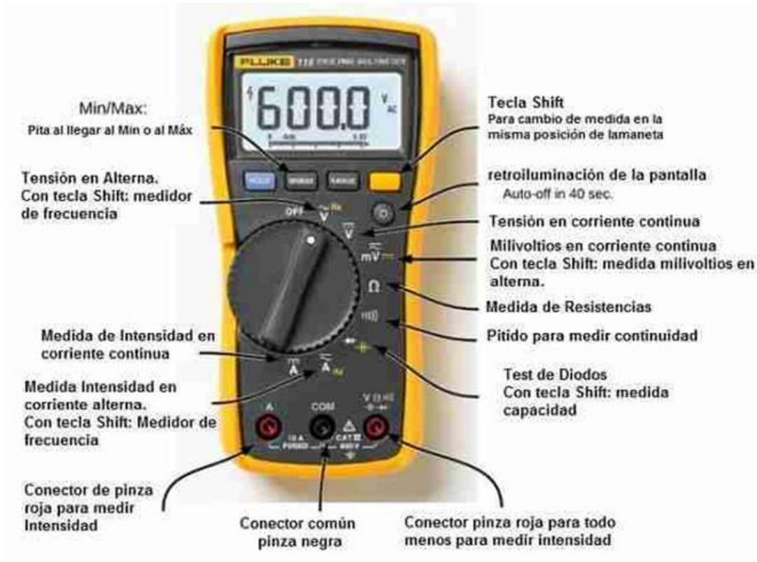
Imagen 3. Partes de un multímetro digital
