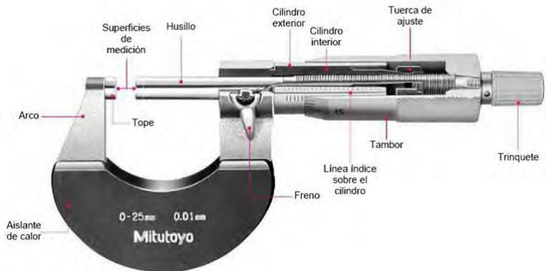
Imagen 2. Partes de un micrómetro
