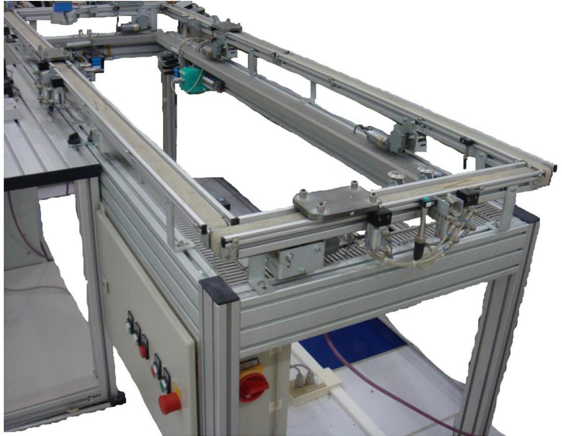
Se utiliza para el transporte de los materiales de una a otra estación según lo requiera el proceso seleccionado
