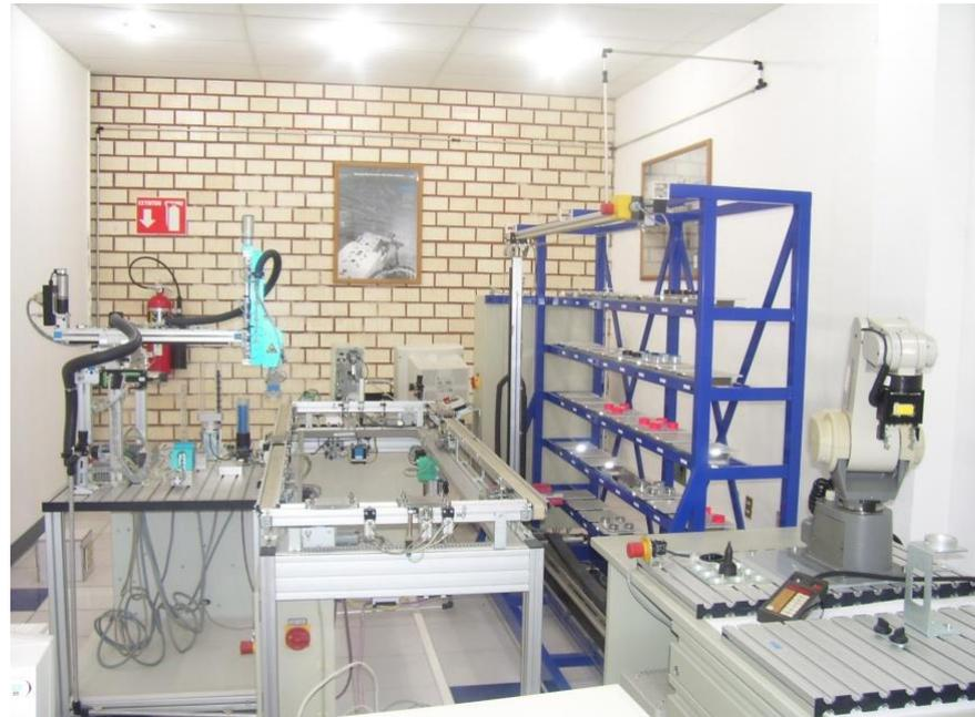
Un FMC es un grupo de máquinas relacionadas que realizan un proceso particular o un paso en un proceso de manufactura más largo. Puede ser, por ejemplo, una parte de un FMS. El aspecto flexible de una celda flexible de manufactura indica que la celda no está restringida a sólo un tipo de parte o proceso, mas puede acomodarse fácilmente a distintas partes y productos, usualmente dentro de familias de propiedades físicas y características dimensionales similares.
