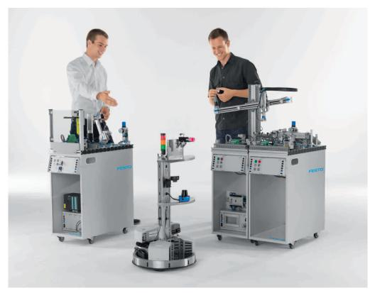
Con Robotino® pueden realizarse las aplicaciones individuales en los ámbitos de la robótica móvil y la robótica de servicio. La torre de montaje permite colocar en cualquier altura de acción componentes estándar o extensiones de desarrollo propio en el Robotino®, así como conectarlos con el control a través de las interfaces facilitadas. De este modo se puede, por ejemplo, convertir el Robotino® rápida y sencillamente de una carretilla de horquilla elevadora en un robot de servicio.
