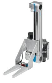
Con la carretilla de horquilla elevadora aplicable Robotino® funciona, por ejemplo, como sistema de transporte sin conductor en un entorno de producción.
