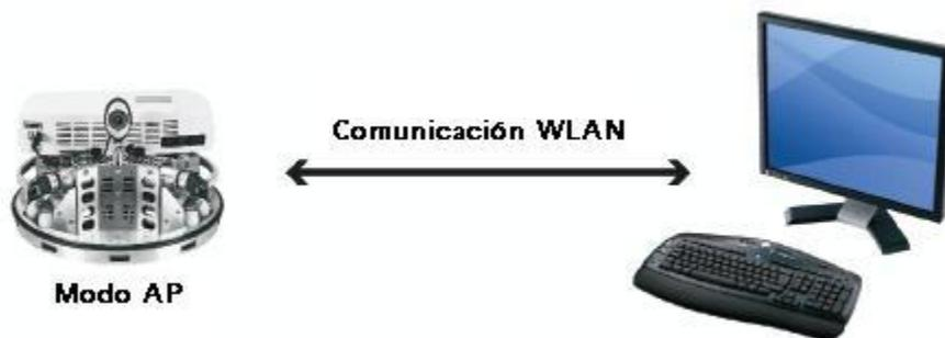
Figura 8.- La comunicación de Robotino hacia una PC o LapTop es mediante WLAN
